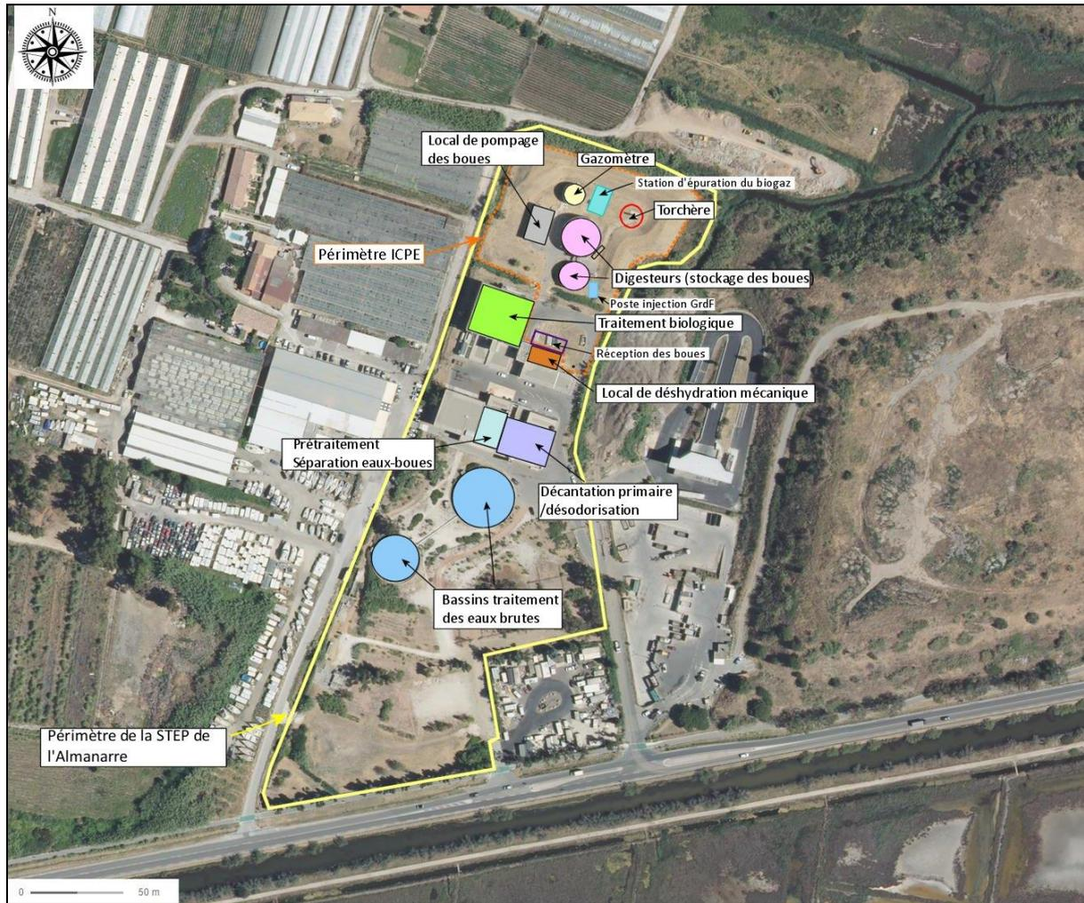
**Figure 2: Installations de la station d'épuration**
